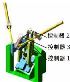
图 5 3-UPS 并联机床振动控制器配置图
